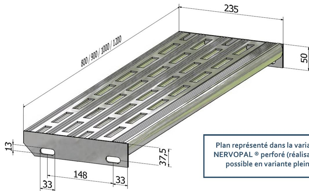
Plan représenté dans la variante NERVOPAL® perforé (réalisation possible en variante plein)
