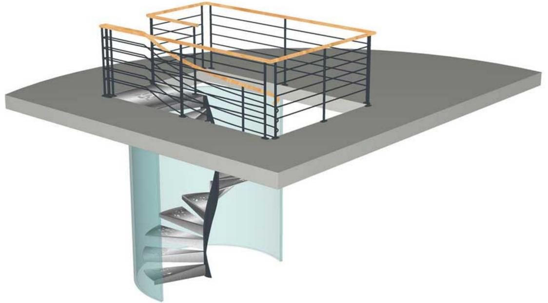
Le logiciel propose **automatiquement** les différentes possibilités de conception de l'escalier en **tenant compte des contraintes** entre le **pas de foulée**, le **giron**, la **hauteur des marches**, la **ligne de foulée**, la **hauteur d'échappée** et la **pente**.
