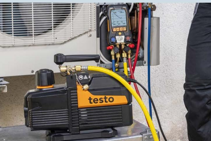
Clapet anti-retour pour éviter une perte de vide en cas de rupture de courant
